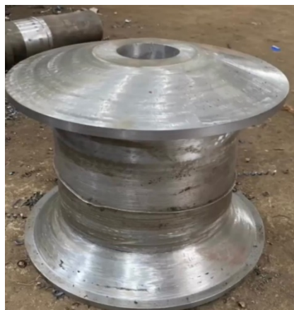
Gambar 4. Akibat Gesekan Tali Kawat Baja
