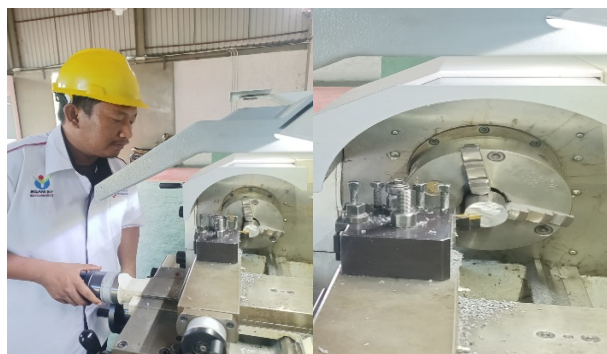
Gambar 5. Pembubutan muka ( facing )
