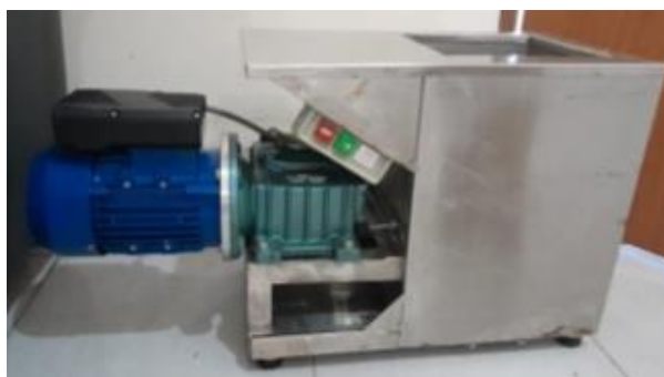
Gambar 1. Hasil Modifikasi Mesin Pengaduk Adonan
